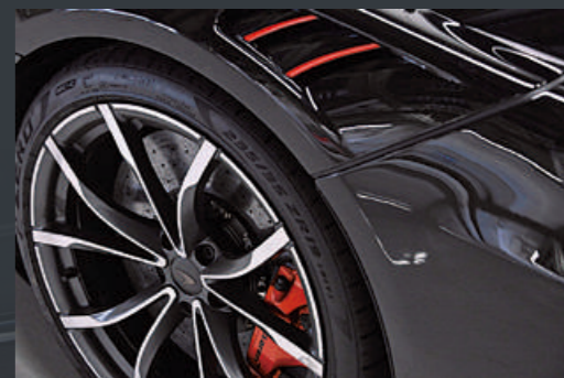
テスト車が装着するタイヤはピレリPゼロ。もちろん承認タイヤとなる。ブレーキはカーボンセラミック製ローターとアルミ製キャリパーを装着。
